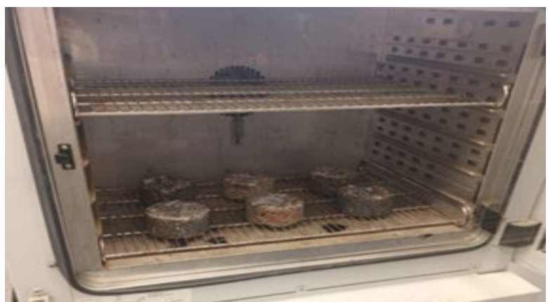
Fot. Wygląd próbek przygotowywanych do badania (kondycjonowanie do temperatury badania w komorze termicznej).
